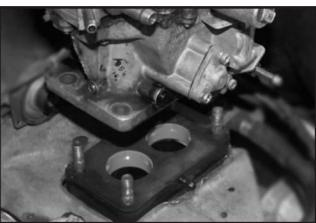
6. Подсоединить воздушный шланг из комплекта к штуцеру Экотоп, установить карбюратор на шпильки и закрепить гайками. Усилие затяжки гаек должно быть не более 0,7-1,6 Нм.
