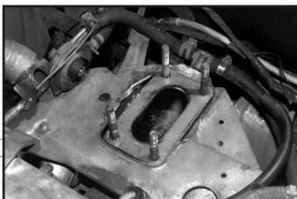
2. Снять штатную теплоизолирующую прокладку.
