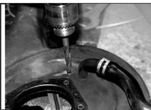
5. В корпусе воздушного фильтра, в зоне между фильтром и карбюратором, необходимо просверлить отверстие для установки штуцера, входящего в комплект поставки.
