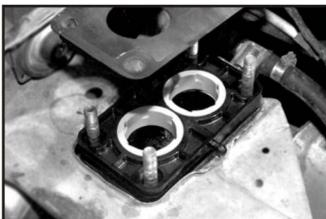
3. Вывернуть штатные (короткие) шпильки из впускного коллектора и ввернуть шпильки M8, прилагаемые к устройству (кроме переднеприводных а/м ВАЗ).
